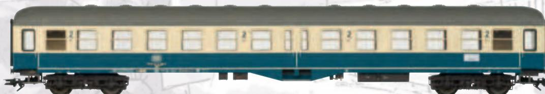
am Wagenende ohne Führerstand. Drehgestelle Bauart Minden-Deutz schwer mit Doppelklotzbremse. Drehgestell vorne mit Schienenräumer, Sifa-Schaltkasten, Indusi und Generator D 62. Länge über Puffer 28,2 cm.
