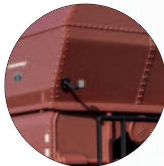
Separat angesetzte Signalstützen an den Stirnseiten
