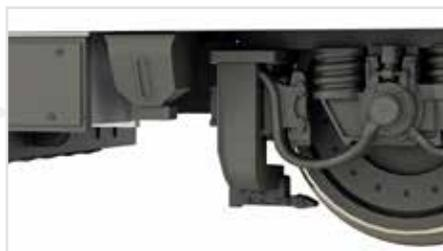
Verstärkte Ausführung der Sandfallrohre
