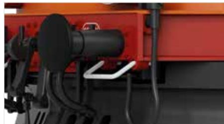
Pufferbohle mit freistehenden Griffstangen und Heizkabel
