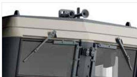
Separat angesetzte Scheibenwischer und Steckdosen
