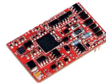
Nach dem Motto Plug & Play unterstützt der PSD XP alle gängigen Datenformate wie DCC mit RailComPlus®, mfx® (nicht bei Next18), Motorola.
