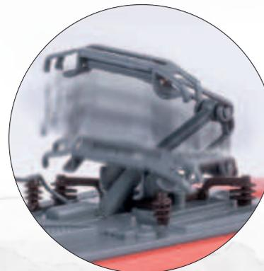
*Mit digital heb- und senkbaren Dachstromabnehmern
