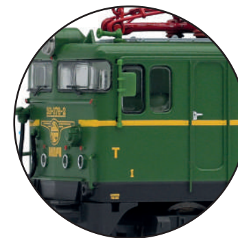
Ventanas frontales y laterales sin reformar
