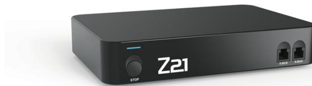
Die Z21 Digitalzentrale verbindet über WLAN Ihre Modellbahnanlage, digitale Loks und Waggon mit Ihrem Tablet, Smartphone oder der Z21 WLANMAUS. Keine erweiterten Netzwerkkennnisse erforderlich. Sie lässt sich leicht durch eine Vielzahl an Schnittstellen erweitern und ist auch die ideale Basis für eine PC-gestützte Automatisierung.
